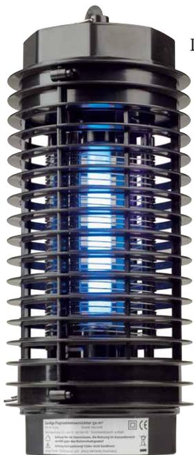
Das Gerät ist mit einer blau leuchtenden Leuchtstoffröhre ausgestattet, die einen hohen UV-Anteil abstrahlt. Das lockt Insekten an. Wie ein Zaun sind rund um diese Röhre elektrisch geladene Drähte gewickelt. Kommen die Insekten damit in Berührung, werden sie von einem Stromschlag getötet.
