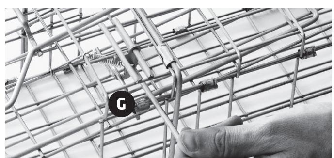
6. Premere sulla staffa di bloccaggio per poter piegare lo sportello anteriore verso l'alto. Questo si blocca automaticamente nel gancio di fissaggio della porta.
