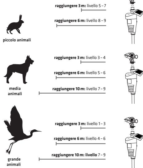
**Suggerimento:** Se si vuole limitare o dirigere o limitare il rilevatore di movimento, è possibile coprire l'obiettivo con nastro adesivo che non faccia passare i raggi solari, o attraverso un cerotto.
