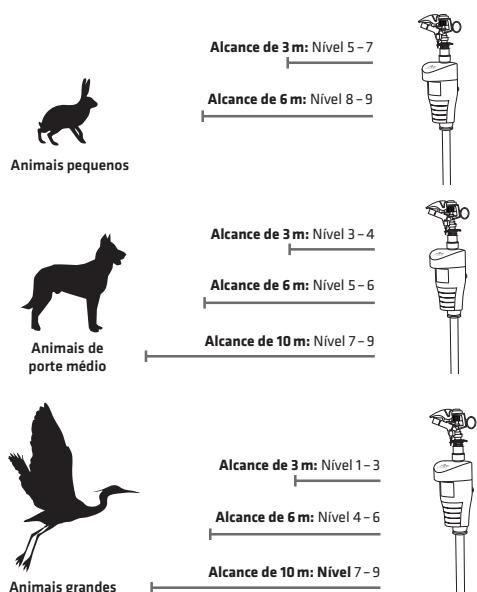
**Dica:** Se você quiser restringir ou direcionar o campo de detecção do sensor de movimento, pode cobrir a lente com fita adesiva opaca ou fita isolante.
